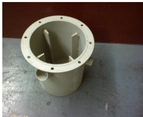
REACTOR EN POLIPROPILENO
